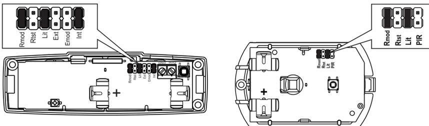
\* В дополнительных датчиках, приобретаемых отдельно от комплекта Security Hub, вилки **Rmod** и **Lit** должны быть замкнуты переключечками.
